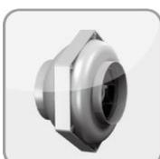
Rohrventilatoren mit Außenläufermotor sind 100 % stufenlos spannungssteuerbar. Die Rohrventilatoren der Baureihe RS100 bis RS 315L werden in Kunststoffgehäusen geliefert. Die Baureihe R100 bis R400 in Stahlgehäusen, pulverbeschichtet grau nach RAL 7032.
